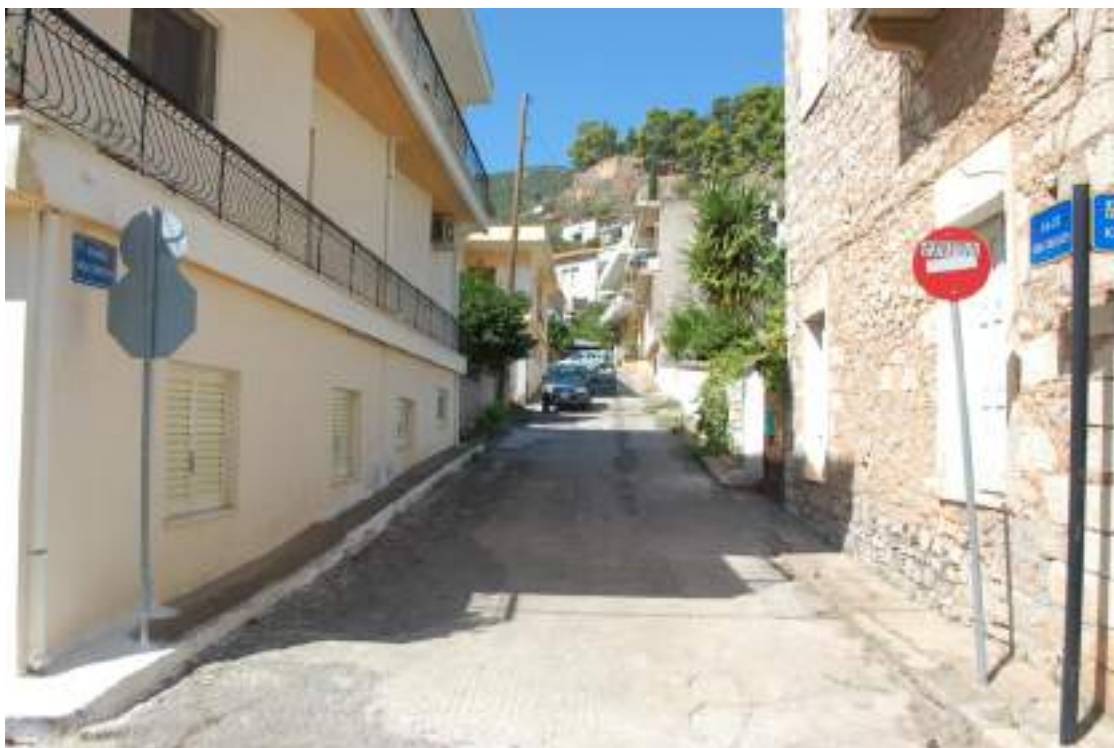
Εικόνα 4.7: Λανθασμένη τοποθέτηση σήμανσης P-2 «STOP» κάτω από P-27 στην οδό Πανταζή (Λήψη από Κοττορού)
