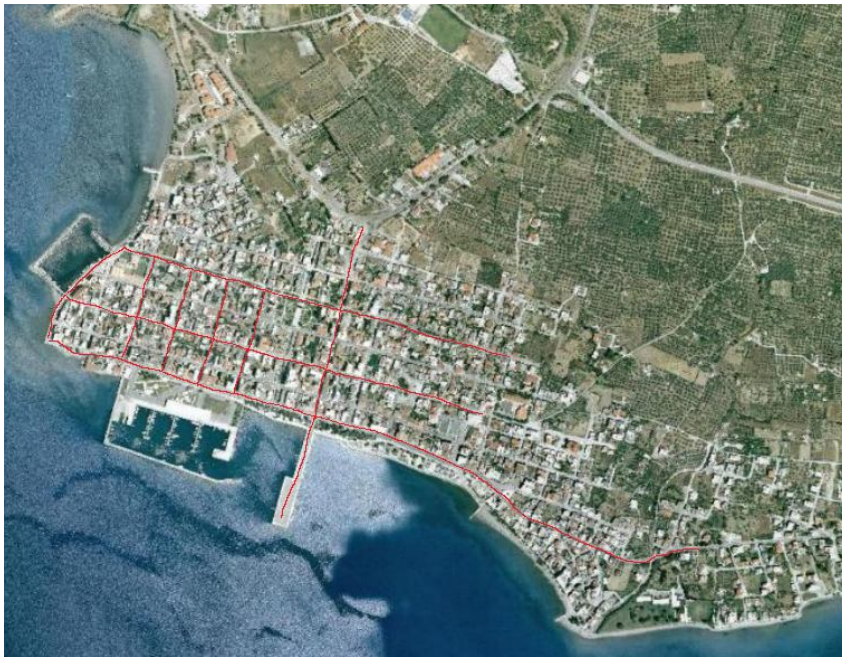
Σχήμα 5.15 : Προτεινόμενη χωροθέτηση ποδηλατοδρόμου στην πόλη της Ιτέας
