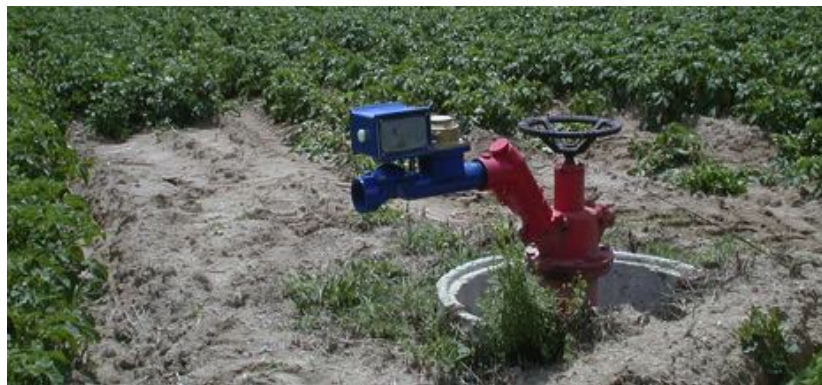
Σχήμα 5.1 : Συσκευή για την ηλεκτρονική υδροληψία
