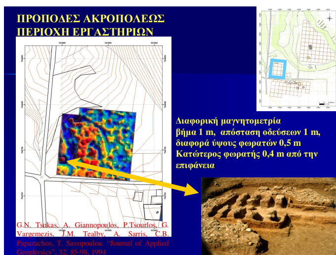
Εικ. 3. Χώρος διασκόπησης, επεξεργασία μετρήσεων καννάβου, εντοπισμός υψηλού μαγνητικού πεδίου και προϊόν ανασκαφικής έρευνας.
