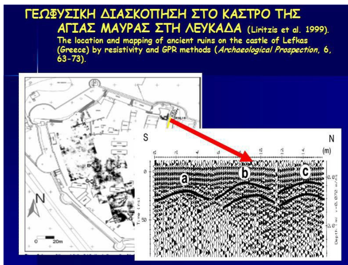
Εικ. 4. Διασκόπηση με γεωραντάρ στο Κάστρο Αγία Μαύρα Λευκάδας και ένα παράδειγμα αποκάλυψης αψίδων θυρών που είχαν εντοιχισθεί από μεταγενέστερες επεμβάσεις
