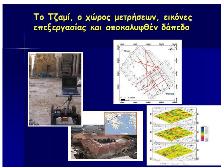
Εικ. 7. Στη Θεσσαλονίκη, στο Τζαμί Hamza Bay, εφαρμόστηκε το Γεωραντάρ και ηλεκτρόμετρο, όπου εντοπίστηκε δάπεδο και άλλες δομές.
